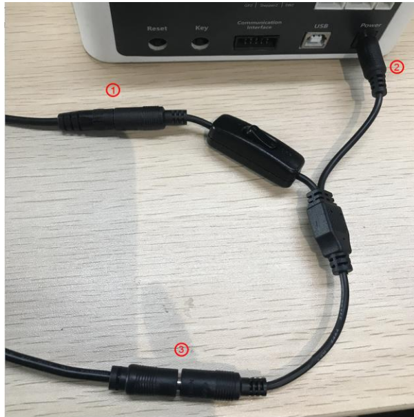
图 2.18 Magician 连接光源
