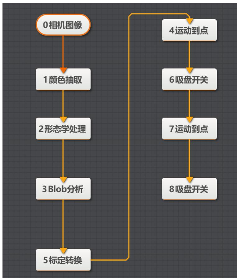
图10-7 方案流程图
