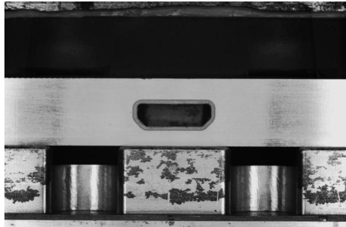
图9-1 CNC 梯形 USB 孔
