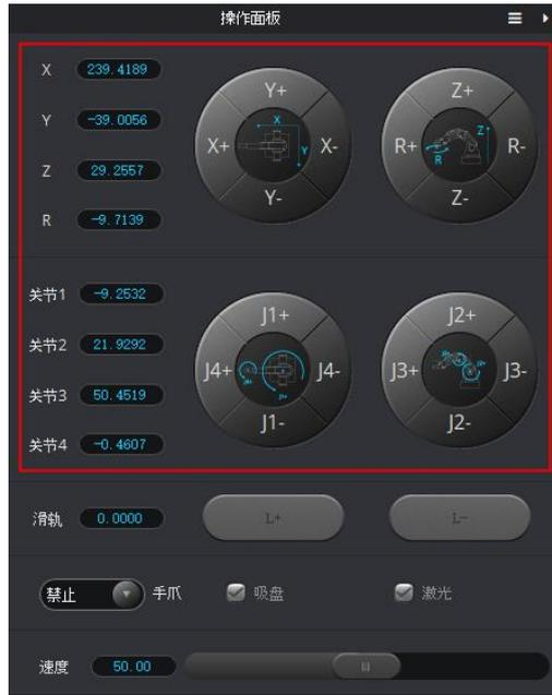
图 2.20 点动坐标系实现示教再现
