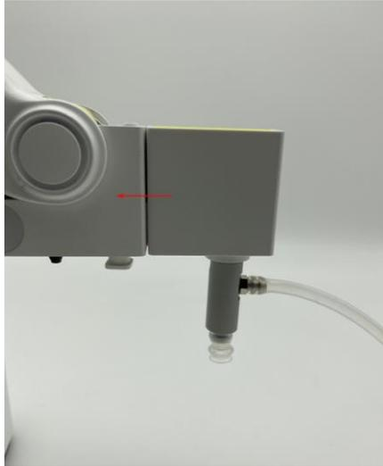
图 5.9 安装吸盘套件
