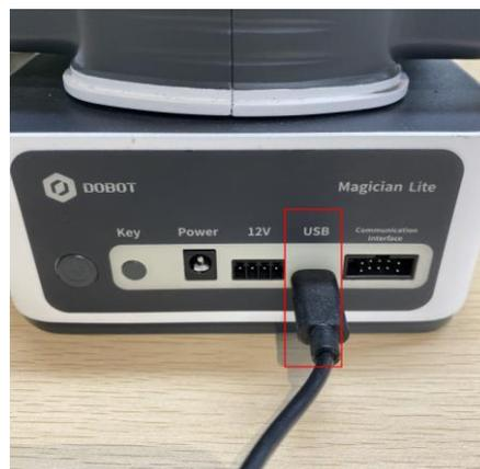
图 2.2 连接 Magician Lite 和计算机
