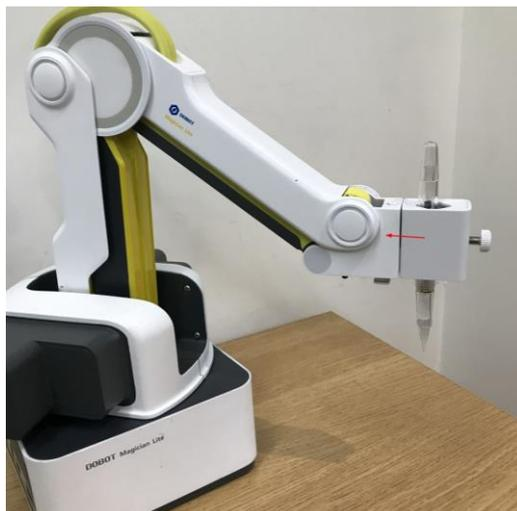
图 5.34 安装写字套件
