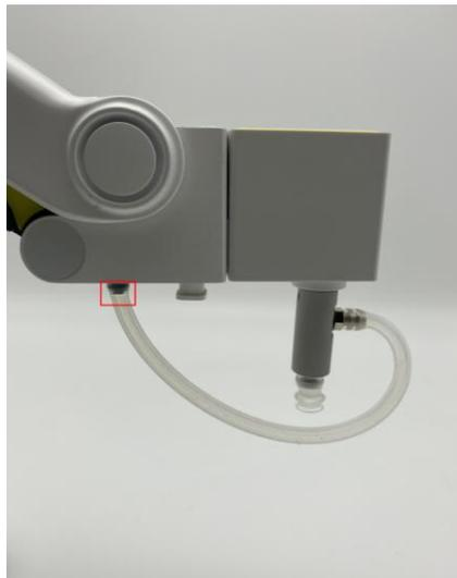
图 5.10 安装气管
