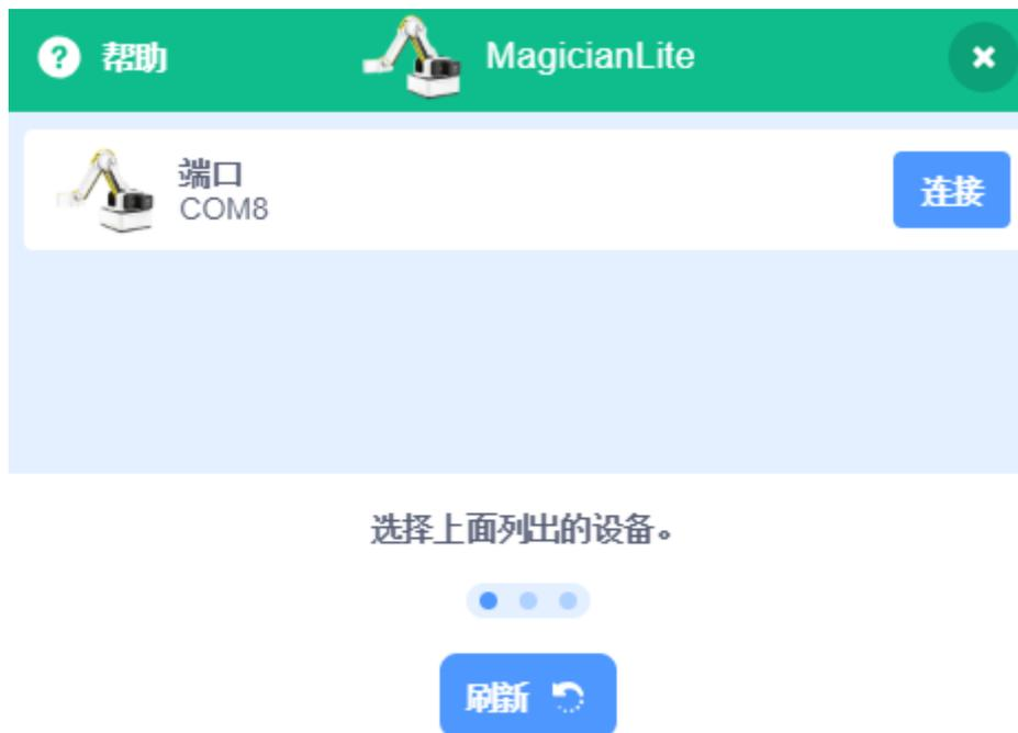
图 3.1 连接 Dobot Magician Lite 和 DobotScratch
