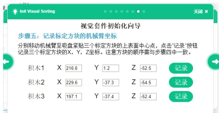
图 4.26 记录标定方块的机械臂坐标
