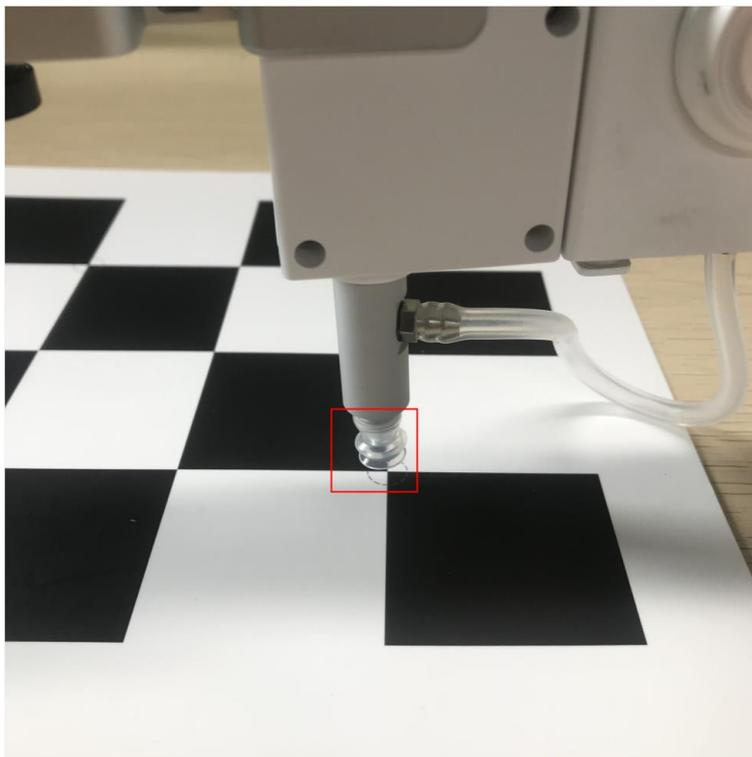
图 4.4 末端对准标定点
