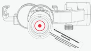
拆包后请将电池尾座旋出，
