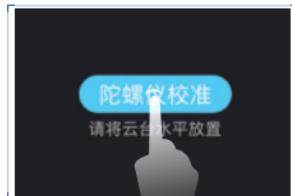
**1.**点击后，将稳定器静放在静止不动的平台（如桌面）上，根据页面提示确定进行校准，5s即可完成校准。
