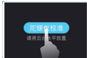
**1.**點擊後，將穩定器靜放在靜止不動的平臺（如檯面）上，根據頁面提示確定進行校準，5s即可完成校準。
