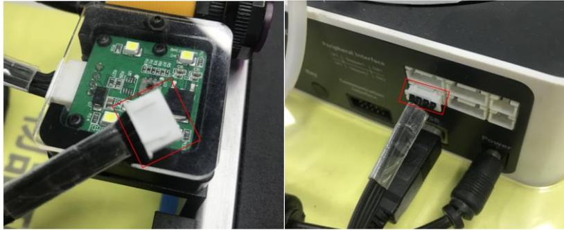
图 2.3 颜色传感器连接
