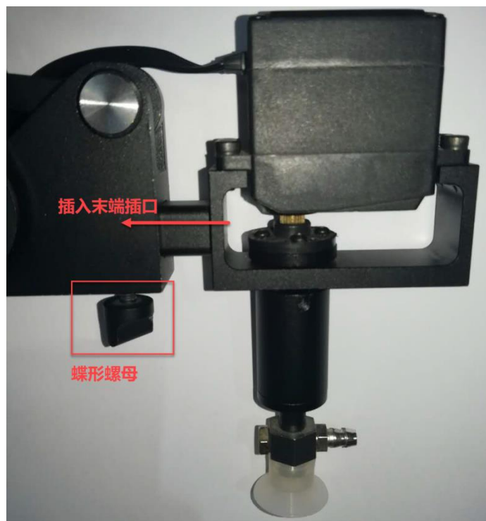
附图 2 安装吸盘套件
