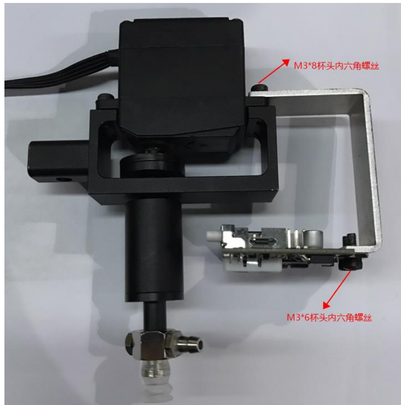
附图 7 安装 Pixy2 视觉识别模块
