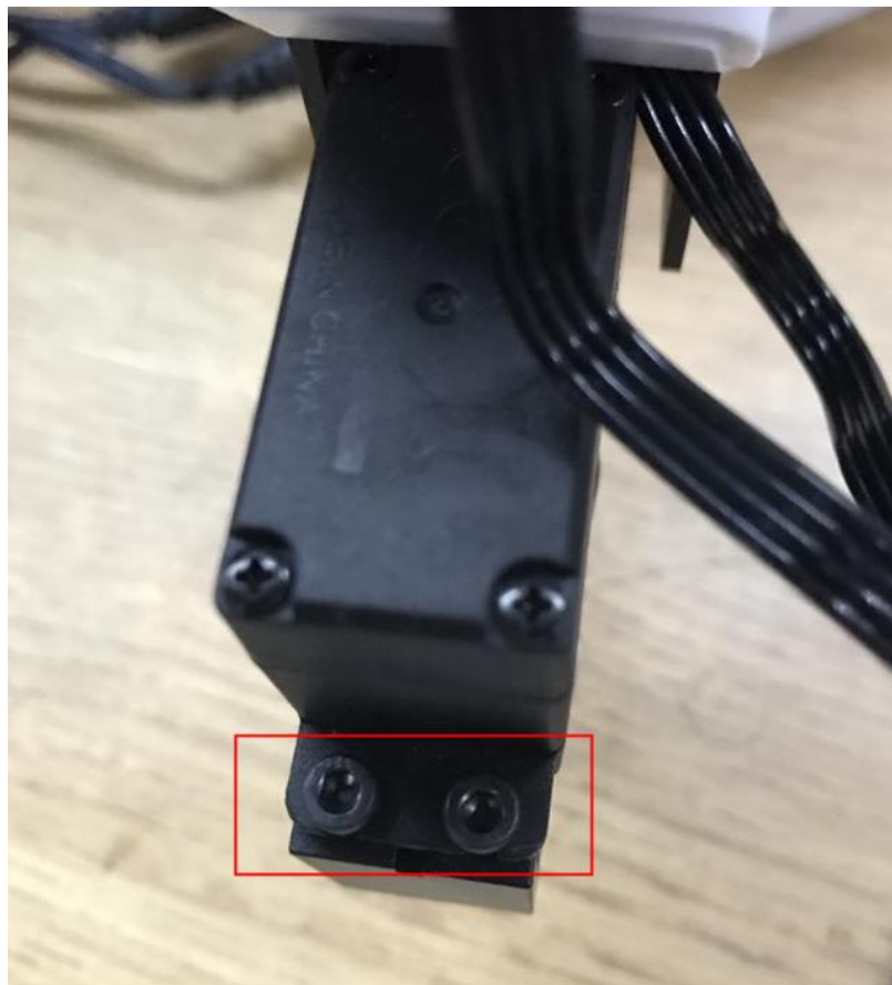
附图 6 松开舵机上的螺丝
