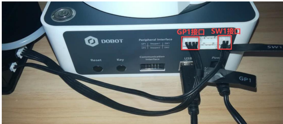
附图 1 连接气泵盒和机械臂
