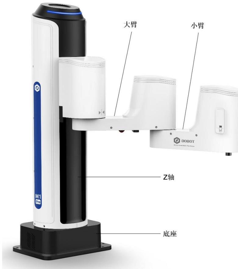
图 2.1 Dobot M1 Pro 外观示意图
