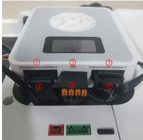
图 3.2 Magic Box 顶部接线图
