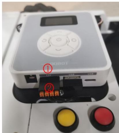
图 3.3 Magic Box 底部接线图
