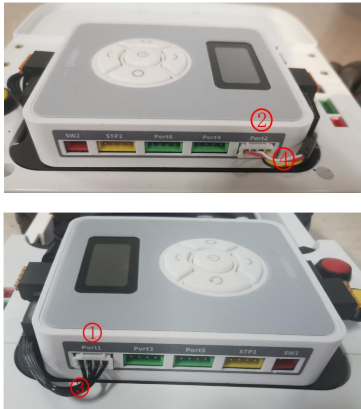
图 3.4 Magic Box 侧面接线图
