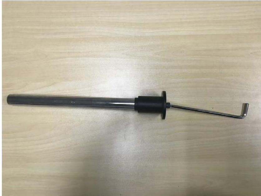
图 2.1 安装摄像头法兰支座
