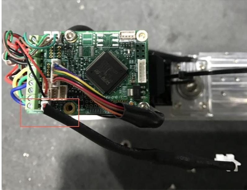
图 7.10 电池转接线接入电池接口
