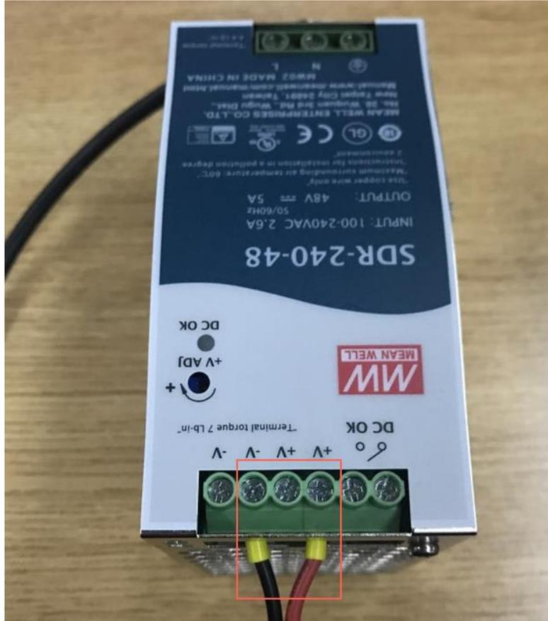
图 5.5 连接电源输出线缆和电源适配器
