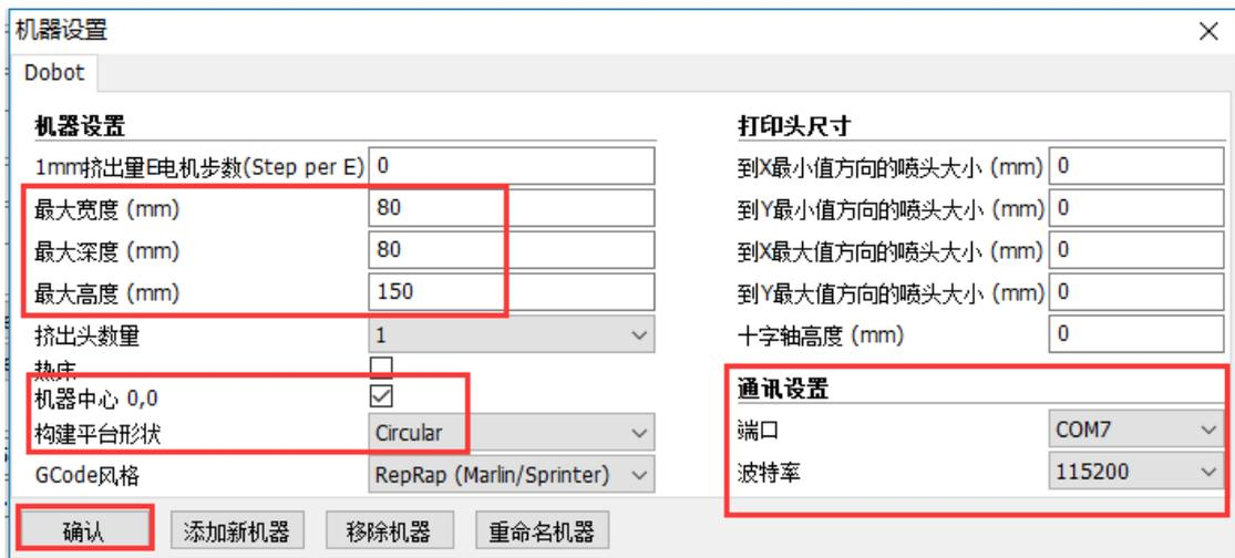
图 6.22 3D 打印界面参数设置
