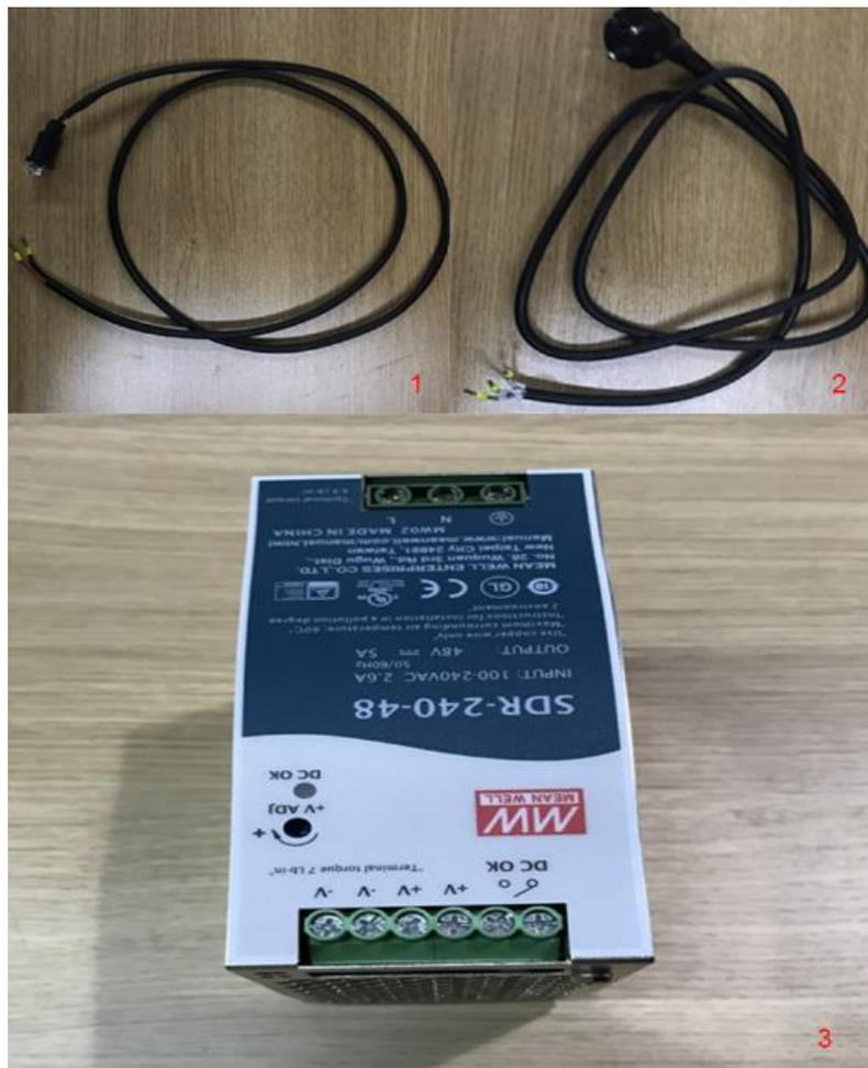
图 5.3 电源连接线和电源适配器
