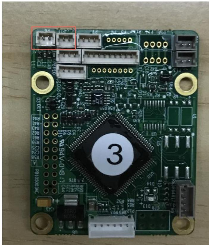
图 7.11 驱动板上的电池接口
