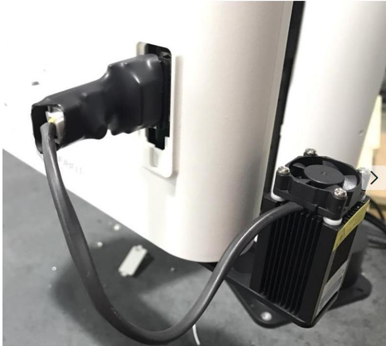
图 3.4 连接末端 I/O
