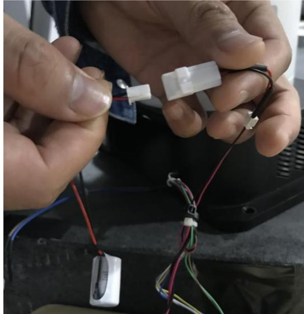
图 7.5 断开电池连接头与电池转接线
