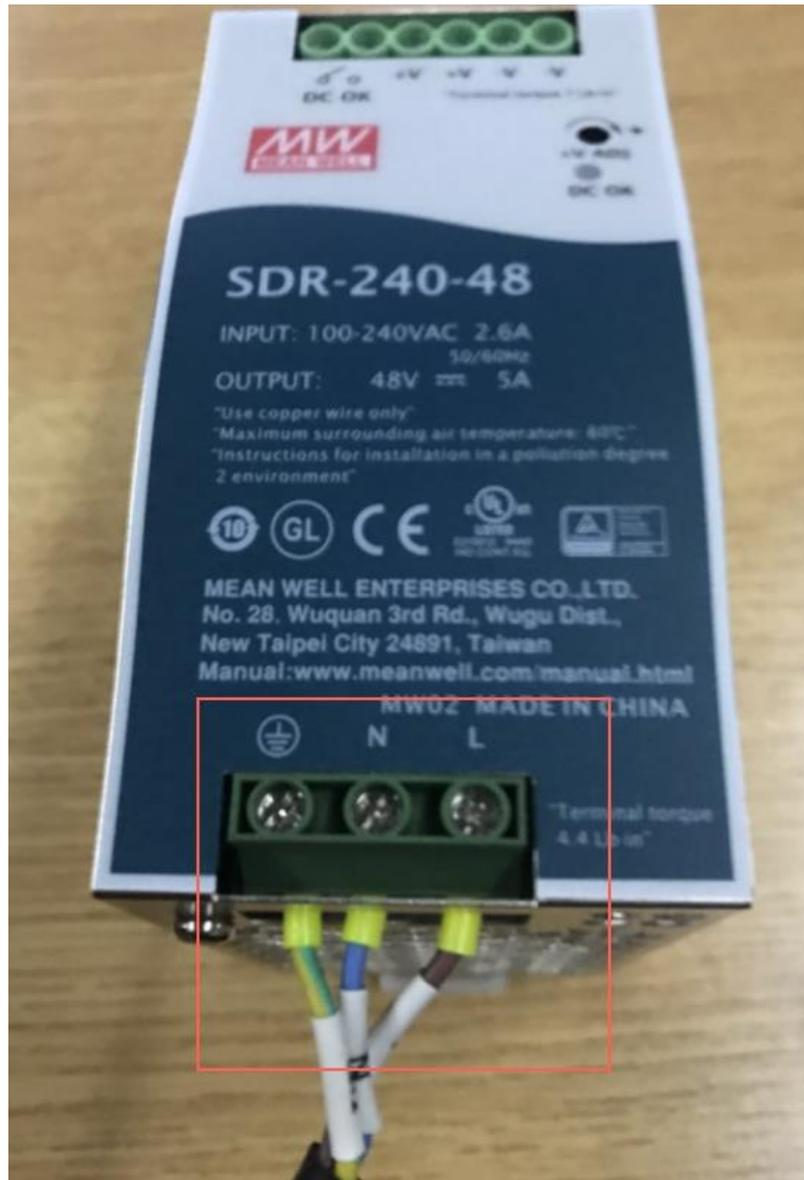
图 5.4 连接电源输入线缆和电源适配器
