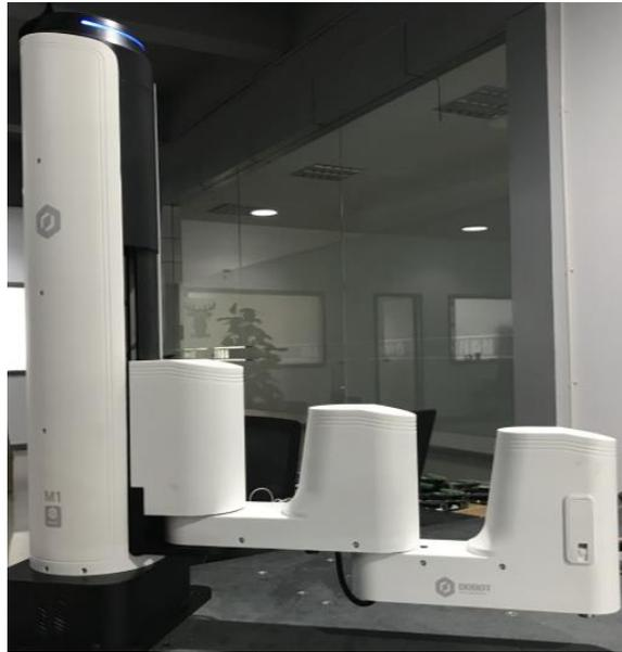
图 7.17 机械臂出厂校准位置
